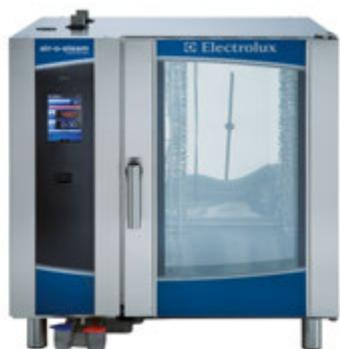
Heißluftdämpfer air-o-steam® Touchline, elektrisch, 10 x GN 1/1, 3 Betriebsarten (automatisch, Rezeptprogramm, manuell), air-o-clean-Reinigungssystem, Boiler, Feuchtigkeitskontrolle (Lambdasonde) 6-Punkt K.T.-Fühler, USB-Schnittstelle
