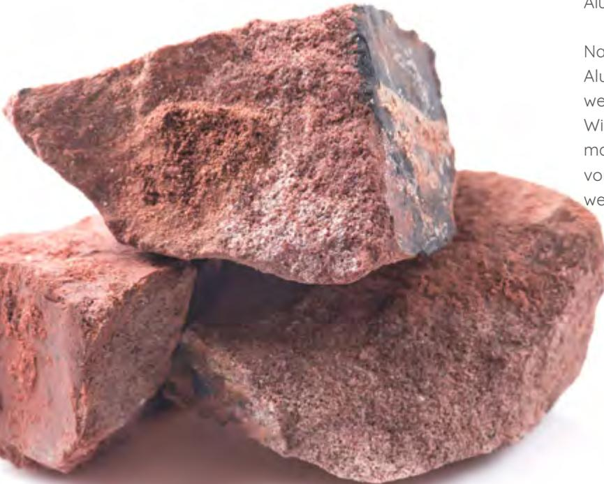
Um Aluminium zu erzeugen, sind aufwendige und energieintensive chemische Verfahren notwendig. Mit Natronlauge wird Aluminiumoxid aus dem Bauxit extrahiert. Durch ein Verfahren, das sich Elektrolyse nennt, wird dann daraus reines Aluminium gewonnen.
