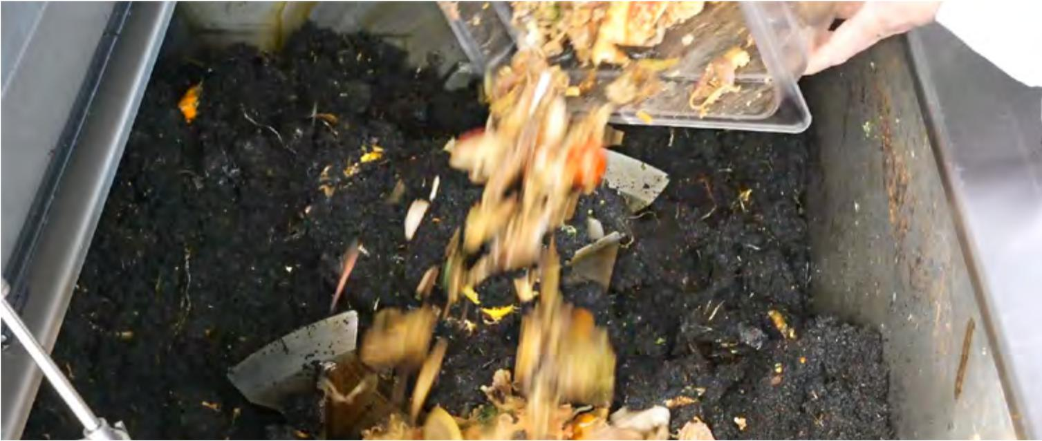
Ein Rotor durchmischt den eingefüllten Müll, dabei wird die Masse stark erhitzt, um ihr die Feuchtigkeit zu entziehen. Der dabei entstehende Wasserdampf wird über ein Filtersystem ausgeleitet. Bakterien erledigen die übrige Arbeit und bauen Proteine, Fette und Cellulose in Hochgeschwindigkeit ganz natürlich ab.
