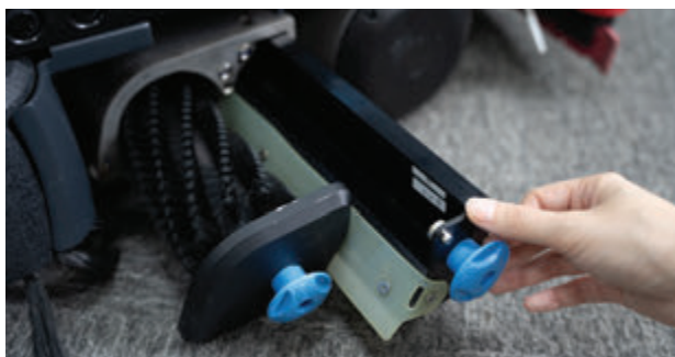
Kehrlade und Bürsten lassen sich leicht entfernen
